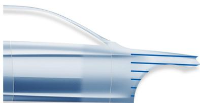
Appliquer la Base Mate Standoblue sur le reste de la zone réparée (apprêt) en procédé normal 1,5 couche. Pression de pulvérisation 1,5-2,0 bar.
