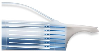
Appliquer 1 couche de Base mate Standoblue jusqu'au bord du raccordeur Standoblue Color Blend 8570/8580 et l'étendre dans la zone/l'élément adjacent. Poursuivre en appliquant une couche d'effet pour raccorder dans le raccordeur humide Standoblue Color Blend 8570/8580.
