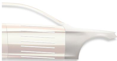
Appliquer une couche fermée de raccordeur Standoblue Color Blend 8570 / Standoblue Color Blend Slow 8580 durci (raccordeur +5% de Durcisseur Standoblue 8550) sur les zones de raccord adjacentes, en évitant les bords extrêmes de l'élément.
