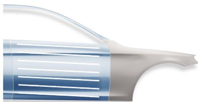
Appliquer Standoblue Color Blend 8570 / Standoblue Color Blend Slow 8580\* en fines couches fermées sur la zone de transition voisine ou sur les éléments adjacents. Ne pas laisser désolwater Standoblue Color Blend 8570/8580.
