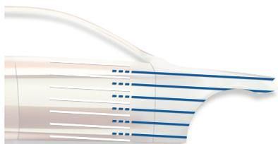
Appliquer la teinte de fond Standoblue avec durcisseur sur le bord du Standoblue Color Blend 8570 / Standoblue Color Blend Slow 8580 encore humide et sur les surfaces réparées. Voir la page des détails de mélange pour l'ajustage du produit et les ratios de durcisseur. Désolvater et sécher comme indiqué sur la page précédente.
