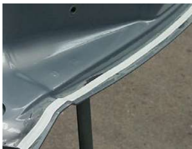
Permet la réalisation de joint de serti de haute qualité
